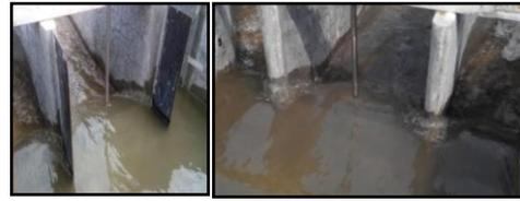
**Gambar 16** Aliran pada Pilar Tipis Plat Baja (Kiri) dan Pilar Beton (Kanan)
